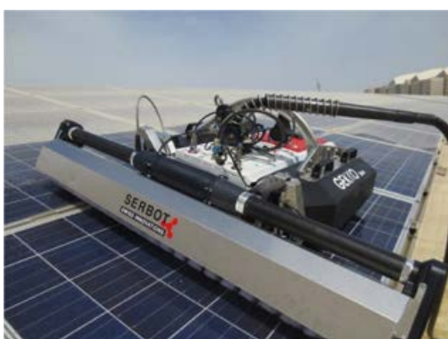
24. ábra: Modultisztító robot, munka közben
