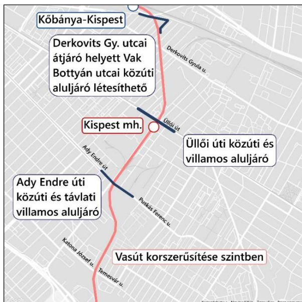
A Kőbánya-Kispest – Kispest szakasz kialakításának vázlata 1. változat
