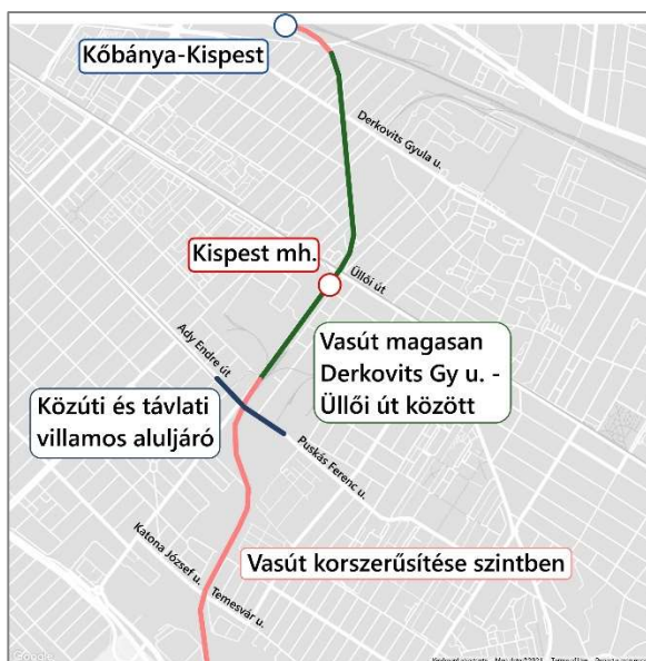
A Kőbánya-Kispest – Kispest szakasz kialakításának vázlata, 3. változat
